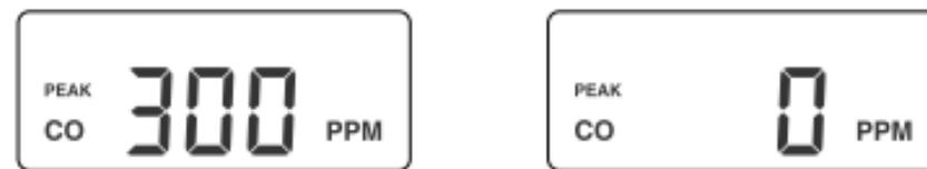
**CO-Spitzenkonzentration Zurücksetzen:** Während die 5 Sekunden, wenn die LCD die CO-Spitzenkonzentration anzeigt, drücken und halten Sie die Test-Taste für 3 Sekunden, das Gerät piept, die LED blinkt grün, und die CO-Spitzenkonzentration wird zurückgesetzt und die LCD wird "0" anzeigen.
