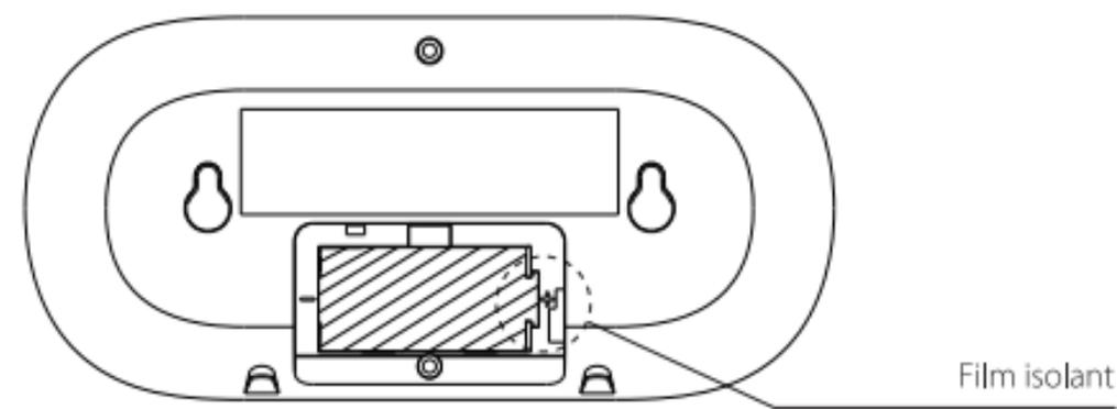
Avant l'utilisation, retirez le film isolant de la pile du logement de celle-ci pour mettre l'appareil sous tension. Une fois l'appareil allumé, le détecteur émet un bip, le rétroéclairage LCD s'allume et l'indicateur LED clignote pendant 8 cycles (jaune / vert / rouge). L'appareil se met ensuite en mode veille.
