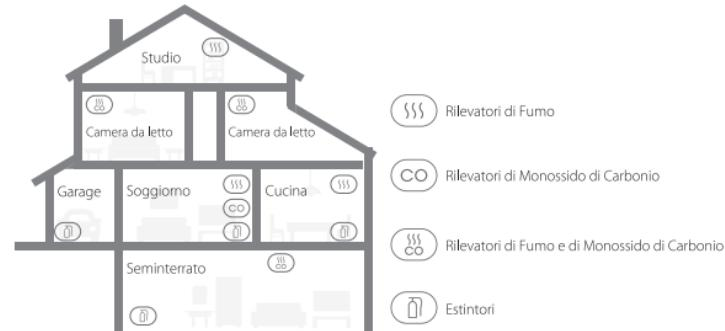
**NOTA:** Quando si installa un rilevatore di fumo in cucina, assicurarsi che il pulsante silenzio sia accessibile ed installarlo il più lontano possibile da fornelli e lavelli per evitare eventuali falsi allarmi.
